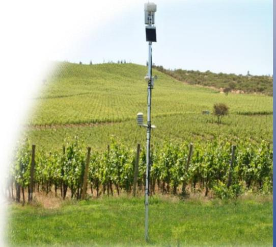
En el Convenio de Cooperación en Riego cuenta con tres EMAs, instaladas en los sectores de Mariposas, Bajo Lircay y Bramadero. El objetivo es proporcionar información agroclimática en línea para entregar una herramienta para realizar un manejo eficiente del agua a través de la programación del riego.
