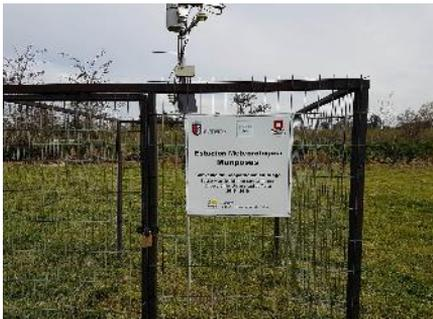
En la parcela además se instaló una Estación Meteorológica Automática en condiciones de referencia que permitirá entregar información en tiempo real respecto de las condiciones agro-climatológicas del sector (temperatura, viento, humedad relativa, radiación, precipitación y evapotranspiración de referencia), de modo que los usuarios puedan tomar mejores decisiones al momento de regar sus cultivos.
